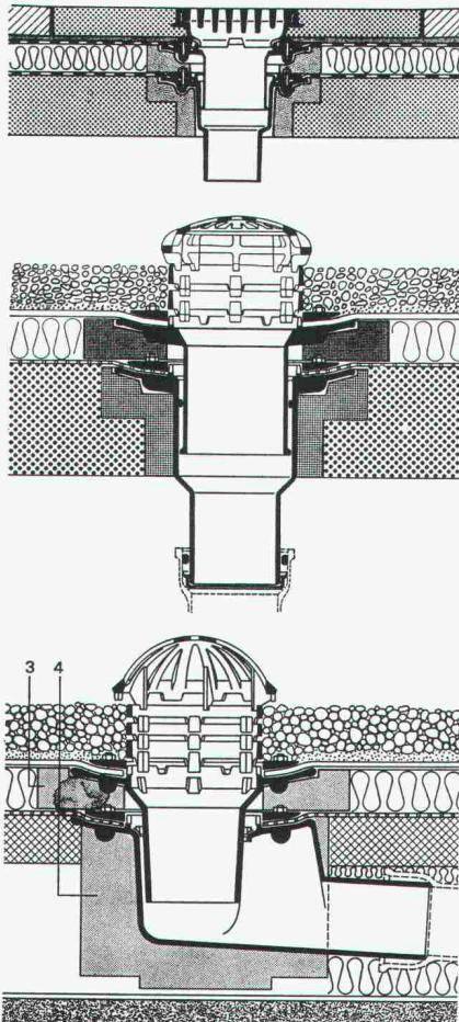
Flachdachablauf Guss zweiteilig, seitl. Auslauf 3° mit Kugelrost, Isolierring, Isolierkörper, Distanzringe 25+35 mm Höhe.
