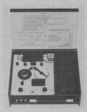
Das Transportstossmessgerät ist darüber hinaus zu verwenden bei der Entwicklung von Verpackungen, zur Untersuchung von Frachtbehältern, zur Überwachung von Boden- und Gebäudeschwingungen als Folge von Detonationen, starkem Verkehr oder ähnlichem. Für Spezialaufgaben stehen besonders hochempfindliche Beschleunigungsaufnehmer zur Verfügung. Brüel & Kjær (Schweiz) AG, 8180 Bülach
