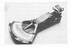
Bild 7. Der optische Schreib-Lese-Kopf (rechts) ist auf einem Arm montiert. Ein Linearmotor dient sowohl zum schnellen Zugriff als auch zum Nachführen des Kopfes über der gewünschten Spur
