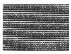
Bild 4. Mit dem Elektronenstrahlmikroskop angefertigtes Bild. Es zeigt die in die Speicherplatte eingeprägten Spuren
