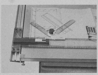
rungsprofil eloxiertem aus Leichtmetall. Die Zeichenschiene ist mit Kugellagern ausgerüstet, die eine präzise und leicht-gängige Führung auf dem Leichtmetallprofil garantieren. Durch Druck auf die Taste wird die Arretierung gelöst; nach Loslassen derselben ist die Zeichenschiene sicher arretiert. Auch eine ständige Freilaufstellung ist möglich.
