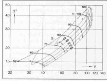
Bild 3. Turboladerverdichter-Kennfeld VTR 454 n: bezogene Drehzahl (%), v: bezogener Luftdurchsatz (%), Es: isentroper Wirkungsgrad bezogen auf Totalzustand (%), π\*: Verdichter-Totaldruckverhältnis, S: Pumpgrenze
