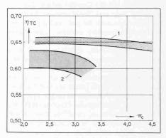
Turboladerwirkungsgrad, Vergleich VTR 454/VTR 501. E TC: Gesamtwirkungsgrad des Turboladers (Bereiche für verschiedene Turboladerspezifikationen), π C: Verdichterdruckverhältnis (1 VTR 454, 2 VTR 501, in Produktion seit 1970, Wirkungsgraderhöhung seit 1975)
