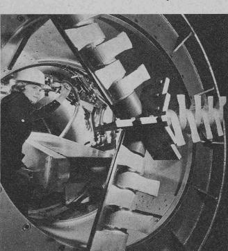
einer herkömmlichen elektrohydraulischen Maschine belaufen, wird durch Druckluft betrieben. Diese wird von einem herkömmlichen «Six-Tool»-Dieselverdichter geliefert, den viele Baufirmen bereits besitzen. Im Vergleich mit elektrischem Betrieb bietet Druckluft den Vorteil des funkenfreien Arbeitens, was für potentiell gefährliche Bereiche wichtig sein könnte. Auch ist die Maschine selbstreinigend, falls Wasser in den Motor eindringt.
