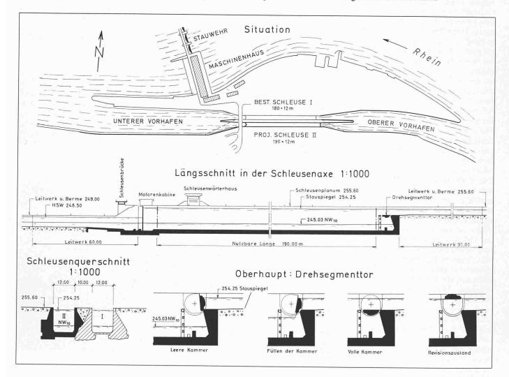
sentrog im Juli 1976 begonnen und rund ein Jahr später programmgemäss beendet werden. Zu den schwierigsten Bauabschnitten in dieser Zeit und am ganzen Schleusenbau überhaupt gehörte die im Herbst 1976 ausgeführte Oberhauptverlängerung zwischen den beiden Schleusenkammern. Da die neue Schleuse 10 m länger ist als die bestehende, musste das neue Oberhaupt unmittelbar neben der von den Schiffen benützten Ausfahrt in den oberen Vorhafen 15 Meter tief ausgehoben und dann aufbetoniert werden.
