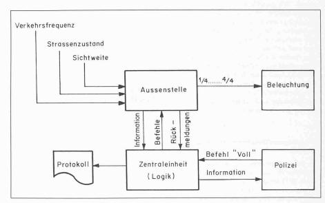
Bild 4. Übersichtsschema des Befehls- und Informationsflusses der Steuerung
