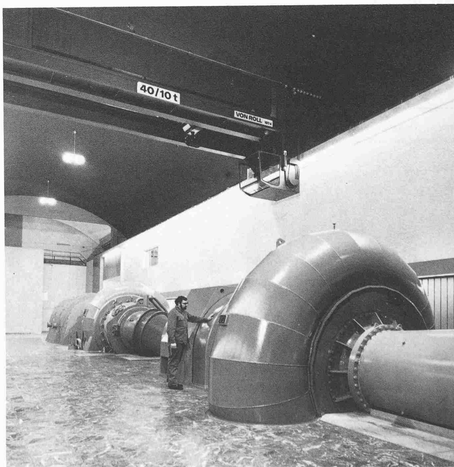
Fig. 7. Pont roulant 40/10 t (portée: 11,10 m): Vue partielle avec cabine de commande vitrée (le câble pour la commande au sol est visible, enroulé contre une paroi de la cabine)
