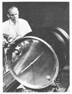
Der Erfinder des «Wärmefasses», Carlyle S. Herrick, bei einer Temperaturmessung am Versuchs-Wärmespeicher. Die Warmluftgebläse links und rechts im Bild simulieren die Sonnenwärmezufuhr. Der dünne Stab in der Fassmitte ist die «Impfstelle» zur Auslösung des Gefriervorgangs, der die gespeicherte Wärme freisetzt
