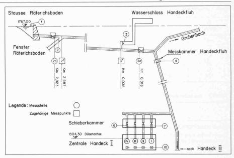
Bild 1. Druckverlustmessungen vom 15. Nov. 1974 und 29. Juli 1975, Schematische Darstellung der Messpunkte. 1, 4: festinstallierte Druckwaage Rittmeyer, 2a, 3a, 6: Präzisions-Röhrenfedermanometer, 2, 3: Gewichtsmanometer, 7: festinstallierte Venturimeter, 10: festinstallierte Energiezähler
