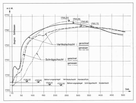
Bild 8. Gemessene und gerechnete Wasserspiegelschwankungen beim Abschaltversuch vom 19. Aug. 1977
