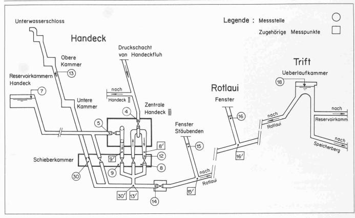
Bild 3. Druckverlustmessungen vom September und November 1976, Schematische Darstellung der Messpunkte. 4, 5, 14, 15, 16, 30: Gewichtsmanometer, 7: Pegel, 8: Ultraschall-Durchflussmessgerät Voith (regulierbare Pumpe), 18: festinstallierte Druckwaage Rittmeyer
