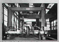
Automatische Schweissanlage für die Herstellung von Trägern mit einer Höhe bis 4,50 m.
