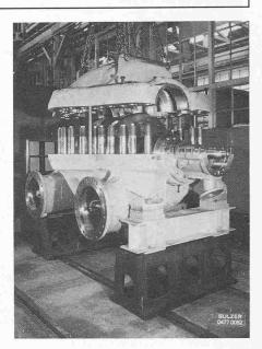
Pumpe HP 75 ede in «split-casing»-Ausführung mit abgehobenem Oberteil.
