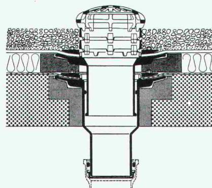
Flachdachablauf Guss zweiteilig, seitl. Auslauf 3° mit Kugelrost, Isolierring, Isolierkörper, Distanzringe 25 + 35 mm Höhe.
