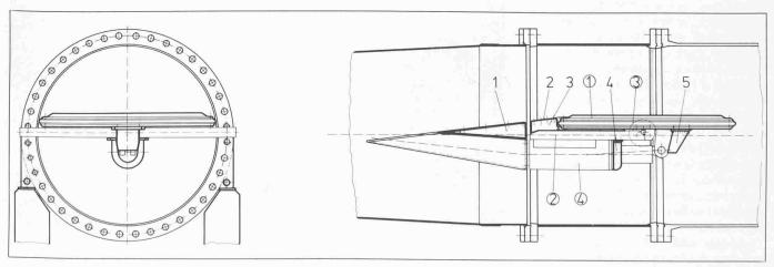
Bild 3. Schwenkklappe. 1 Drehteller, 2 Querträger, 3 Abstützung, 4 Servomotor, 1 ÷ 5 Strömungskörper
