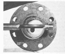
Bild 1. Modell einer Schwenkklappe zur Messung der Druckverluste und der Geschwindigkeitsvertei-
