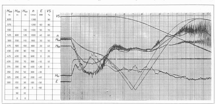
Enregistrements effectués lors d'un déclenchement de l'Isogyre en marche pompe, surchargés des résultats du calcul selon modèle A Fig. 6.
