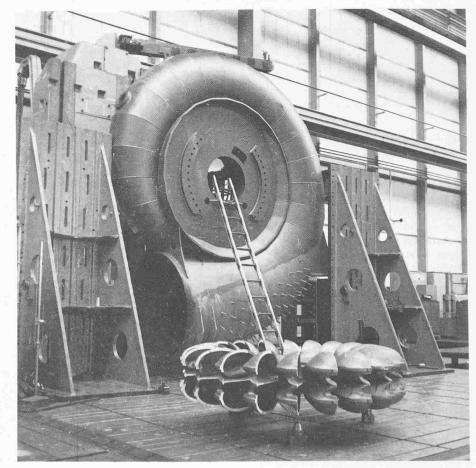
Fig. 1. Bâche spirale dans les ateliers de fabrication
