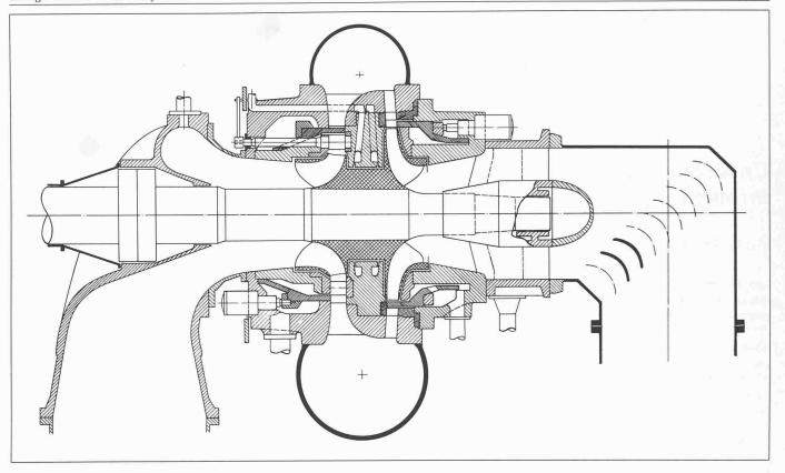
Fig. 1 Coupe longitudinale du groupe pompe-turbine Isogyre
