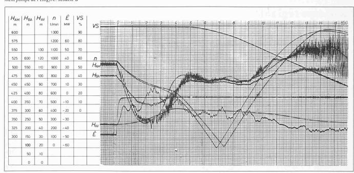
Fig. 8. Enregistrements effectués lors d'un déclenchement de l'Isogyre en marche pompe, surchargés des résultats du calcul selon modèle B
