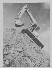
Für den Einsatz als Tieflöffelbagger sind drei verschiedene Ausleger mit maximalen Reichweiten von 7,54 m, 8,69 m und 9,14 m verfügbar. Die Maschine ist daher praktisch allen Arbeitsbedingungen gewachsen. Sie kann mit den verschiedensten Aushubschaufeln bis zu einem Fassungsvermögen von 6001, bestückt werden. Der 108S mit 5,951 Sechszylinder-Dieselmotor (wassergekühlt) leistet 90 PS bei 2100 U/min.
