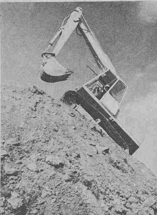
Für den Einsatz als Tiefloßbagger sind drei verschiedene Ausleger mit maximalen Reichweiten von 7,54 m, 8,69 m und 9,14 m verfügbar. Die Maschine ist daher praktisch allen Arbeitsbedingungen gewachsen. Sie kann mit den verschiedensten Aushubschaufeln bis zu einem Fassungsvermögen von 600 l, bestückt werden. Der 108S mit 5,95 l Sechszyylinder-Dieselmotor (wassergekühlt) leistet 90 PS bei 2100 U/min.
