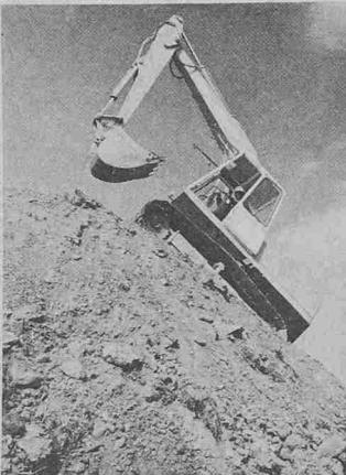
Für den Einsatz als Tiefloßbagger sind drei verschiedene Ausleger mit maximalen Reichweiten von 7,54 m, 8,69 m und 9,14 m verfügbar. Die Maschine ist daher praktisch allen Arbeitsbedingungen gewachsen. Sie kann mit den verschiedensten Aushubschaufeln bis zu einem Fassungsvermögen von 600 l, bestückt werden. Der 108S mit 5,95 l Sechszylinder-Dieselmotor (wassergekühlt) leistet 90 PS bei 2100 U/min.
