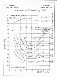
Fig. 4. Caractéristiques de fonctionnement en pompe et en turbine d'une pompe-turbine réversible et plages d'utilisation avec coefficients de pondération pour le calcul des rendements moyens, propres à chaque service
