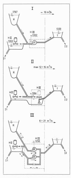
Fig. 1. Schémas de trois projets d'équipement en machines hydrauliques, établis dans le cadre des études de l'aménagement de Handeck III
