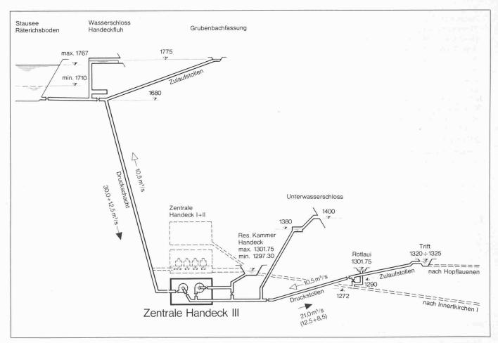
Bild 1. Hydraulisches Schema der Anlage Handeck III
