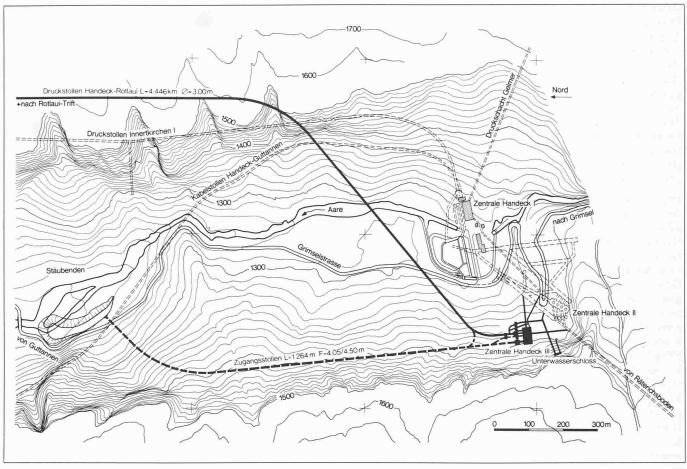
Bild 2. Situationsplan des Kraftwerkes Handeck III
