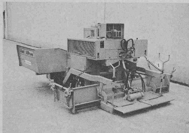
Der Allatt SP-50 hat eine einteilige Vibrationsbohle von 137 cm Grundbreite, die hydraulisch stufenlos bis 251 cm verbreitert werden kann. Das Materialsilo mit einem Fassungsvermögen von 3,6 t ist 291 cm breit und lässt sich mit jedem gebräuchli-
