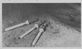
Befestigungselement, das gegenüber den herkömmlichen Kunststoffdübeln wesentliche handhabungstechnische Vorteile bietet. Der neue Hilti-Schlagdübel HPS besteht aus einem Kunststoffdübel (Polyamid) mit vormontierter Nagelschraube als Spreizelement. Dübel einstecken und mit Hammerschlag spreizen – das genügt. Die Hauptvorteile des Hilti-Schlagdübels HPS sind:
