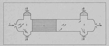
Schema einer Koaleszenzanlage: 1 Zufluss des Öl-Wasser-Gemisches, 2 Schlamm, 3 Öl, 4 Abfluss, 5 1. Abscheidekammer, 6 Koaleszenzkammer, 7 2. Ab-
