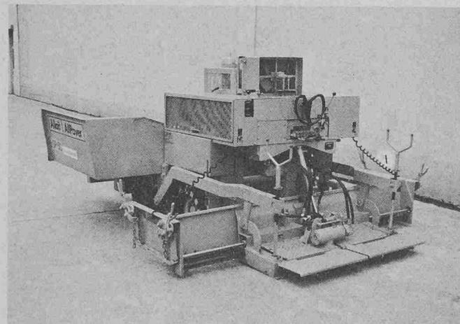
Der Allatt SP-50 hat eine einteilige Vibrationsbohle von 137 cm Grundbreite, die hydraulisch stufenlos bis 251 cm verbreitert werden kann. Das Materialsilo mit einem Fassungsvermögen von 3,6 t ist 291 cm breit und lässt sich mit jedem gebräuchlichen
