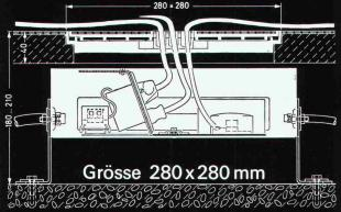
Rahmen in die Bodenplatte, Kasten auf dem darunter liegenden Boden auf höhenverstellbaren Füssen montiert 3 T+T Anschlussdosen 2x3 Steckdosen P+N+E 10 A 220 V
