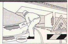
Als universellen thixotropen, gebrauchsfertigen 2-Komponenten-Flickmörtel für die Reparatur von beschädigten Betonoberflächen und Kanten, zum Ausfüllen von Löchern und groben Kiesnestern im Beton oder zur Herstellung von Hohlkehlen, schätzt man in Fachkreisen SikaTop 122 Flickmörtel.
