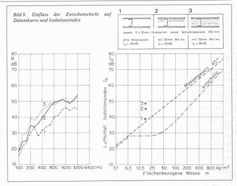
der Dicke der Mineralwollefüllung von 1 über 2 nach 3, Dämmkurve und Isolationsindex in positiver Richtung verschoben werden.
