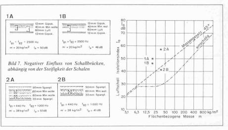
Aufbau gilt: Schallbrücken sind zulässig, wenn beide Schalen eine Grenzfrequenz über 2000 Hz aufweisen. Sie sind tolerierbar, wenn die Grenzfrequenz der einen Schale über 2000 Hz liegt, die der anderen Schale unter 2000 Hz. Schallbrücken sind auszuschliessen, wenn die Grenzfrequenzen beider Schalen unter 2000 Hz liegen.
