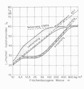
Bild 1. Luftschallisolationsindex von ein- und zweischaligen Bauteilen in Abhängigkeit von der flächenbezogenen Masse. Randbedingungen: Resonanzfrequenz f<sub>R</sub> zwischen 71 und 125 Hz. Grenzfrequenz fg bei Schallbrükken über 200 Hz
