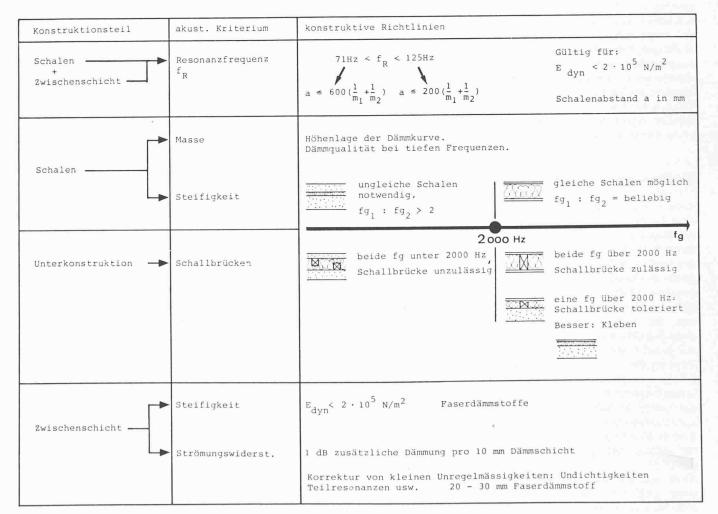
Bild 9. Konstruktionsregeln für zweischalige Bauteile
