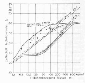
frequenz von 1000 Hz, hat einen Index, der noch unter dem eines einschaligen Bauteils zu liegen kommt.
