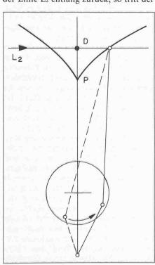
Bild 4. Plötzlicher Umschlag, wenn der längs L2bewegte Fahrstift den Punkt D erreicht
