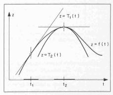
Bild 6. Die Funktion z = f(t) wird in der Umgebung der Stelle  $t_1$  durch das Taylor-Polynom 1. Ordnung, in der Umgebung von  $t_2$  aber erst durch das Taylor-Polynom 2. Ordnung qualitativ befriedigend wiedergegeben
