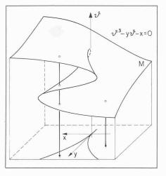
Bild 9. Katastrophenmannigfaltigkeit M über der Parameterebene. Über Punkten (x,y) ausserhalb der Kuspe liegt ein Punkt von M, über Punkten (x,y) innerhalb der Kuspe liegen drei Punkte von M
