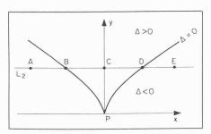
Bild 7.  $\Delta = \Delta(x,y)$  ist die Diskriminante der kubischen Gleichung (\*). Diese Gleichung besitzt eine reelle Lösung  $\vartheta$ , falls  $\Delta < O$ , und drei reelle Lösungen, falls  $\Delta > O$
