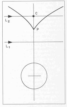
Bild 3. Befindet sich der Fahrstift unterhalb der Kuspe, so gibt es nur eine stabile Gleichgewichtslage der Scheibe; befindet er sich oberhalb, so gibt es deren zwei
