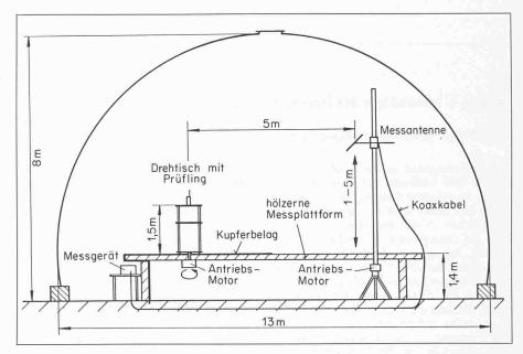
Bild 5. Messplatz: Längsschnitt (schematisch)
