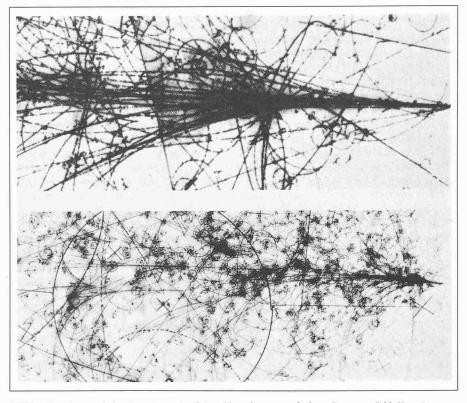
Bild 6. Ein Neutrino hoher Energie tritt in Aktion. Blasenkammeraufnahme. Im untern Bild: Vergrösserung der Wirkungsregion des Neutrinos
