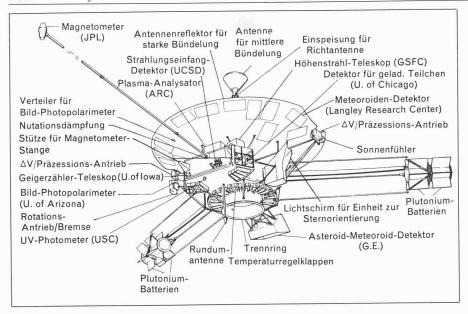
Bild 4. Die Raumsonde Pionier 11 zur Erforschung des Jupiters wurde am 6. April 1973 an der Spitze einer Atlas-Centaur-Rakete gestartet. Der Jupiter wurde am 3. Dezember 1974 in einem Abstand der Fahrbahn von den Spitzen der Jupiterwolken von 4300 km erreicht. Nach dem Passieren des Jupiters flog die Raumsonde weiter in Richtung Saturn und wird diesen Planeten Ende 1979 erreichen. Pionier 11 ist das erste Objekt aus Menschenhand, das nennenswert aus der Ekliptikebene herausfliegt.
