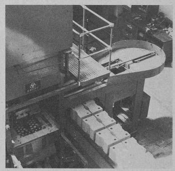
und ausgeprägtere Kantenschärfe sind das Ergebnis, Eigenschaften, die hauptsächlich die Produktion hochwertiger Spar-, Spalt- und Bruchverblendsteine für Sichtmauerwerk erfordert.
