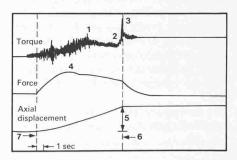
Bild 6. Typische Messgeräteaufzeichnung für eine radiale Reibschweissung. 1. Anfangsspitzenwert – 110 Nm. 2. Ausgeglichenheit – 30 Nm. 3. Abschliessender Spitzenwert – 280 Nm. 4. Maximum – 37 kN. 5. Abschmelzeinstellung – 9 mm. 6. Ende des Schweissvorgangs. 7. Schweissbeginn.
