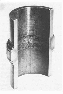
Bild 12. Schnitt durch ein radial reibgeschweisstes Rohr von 110 mm Aussen-Durchmesser und 10 mm Wanddicke
