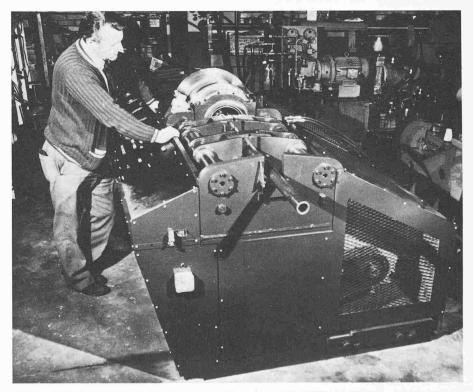
Bild 10. Radialreibschweissmaschine für Rohr mit 50 mm Aussen-Durchmesser
