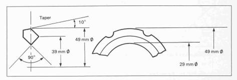
Bild 2. Schiebevorrichtung: Ringgeometrie mit Passfeder-Antriebsnuten
