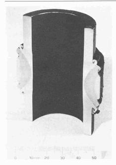
Bild 11. Schnitt durch ein radial reibgeschweisstes Rohr von 50 mm Aussen-Durchmesser und 6 mm Wanddicke
