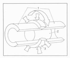
Bild 1. Funktionsprinzip des radialen Reibschweissens. 1. Festgespannte nicht drehende Rohre. 2. Spreizdorn. 3. Integrierender in Drehung versetzter und radial zusammengedrückter Ring
