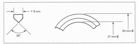
Bild 4. Multifinger-Druckvorrichtung: Einfacher Ring
