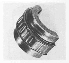
Bild 8. Äusseres Ringprofil einer mit der Mehrbakkenvorrichtung ausgeführten radialen Reibschweis-
