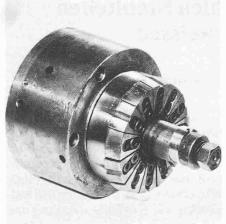
Bild 5. Multifinger-Druckvorrichtung: Hauptkörper mit Mehrfachbacken und Dorn
