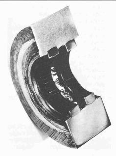
Bild 14. Radial reibgeschweisste (Expansion) Einsatzringe in einem zylindrischen Körper
