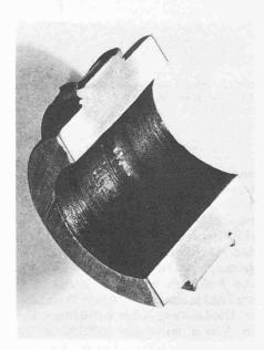
Bild 9. Schnitt durch eine mit der Mehrbackenvorrichtung ausgeführten radialen Reibschweissung
