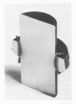
Bild 13. Weiterer Anwendungsfall des radialen Reibschweissens: Aufschweissen (Zusammendrükken) von Kragen auf Wellen
