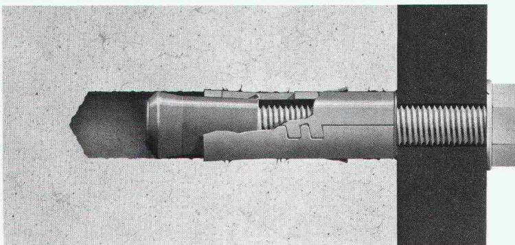
**Der TUFLEX-Schwerlastdübel besitzt eine wirksame Drehsicherung. Und sperrt sich erfolgreich gegen jeden Lockerungsversuch.**
