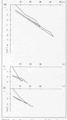
Bild 8. Last-Setzungsdiagramm. 2. Versuch
