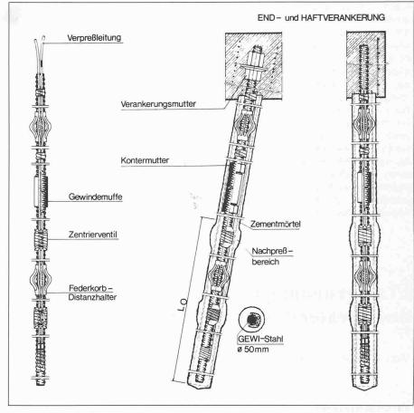
Bild 3. Stahlpfahl mit Nachpress-System. Dywidag Gewi-Pfahl, Durchmesser 50 mm
