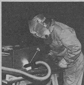
Dank der Schweissrauchabsaugung kann der Schweisser saubere Luft einatmen, und er wird nicht durch den Schweissrauch belastet und gefährdet.
