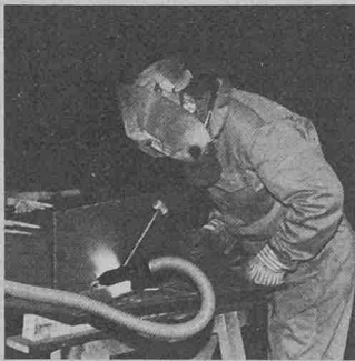
Dank der Schweissrauchabsaugung kann der Schweisser saubere Luft einatmen, und er wird nicht durch den Schweissrauch belästigt und gefährdet.
