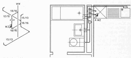
Einbaubeispiel 3 Warmwasserzähler im Schrank neben der Spültischkombination für Wohnung mit Küche und 3-Apparate-Badezimmer. A: Wohnungsabsperrventil. WZ: Wasserzähler
