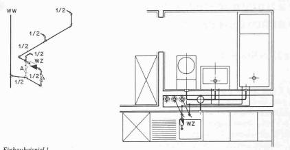
Einbaubeispiel 1 Warmwasserzähler im Hohlraum unter dem Spülbecken für Wohnung mit Küche und 3-Apparate-Badezimmer. A: Wohnungsabsperrventil. WZ: Wasserzähler
