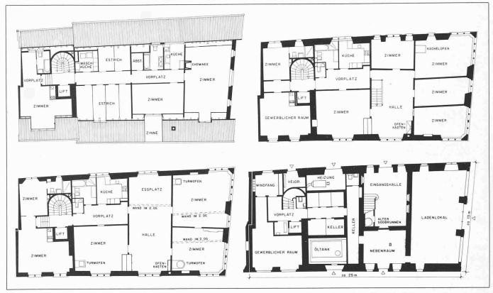
Grundriss Dachgeschoss (oben), Grundriss drittes Obergeschoss; links: das Sigristenhaus, rechts: das «Neuhaus»
