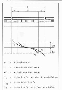
Bild 6. Versagen der Haftverbindung
