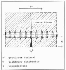
Bild 8. Rissebildung im Stahlbeton (nach GOTO, ACI Journal 68, 1971)
