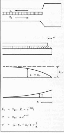
Bild 10. Plattenrand bei Temperaturbeanspruchung
