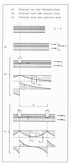
Bild 2. Kräfte und Verformungen am Rissemodell
