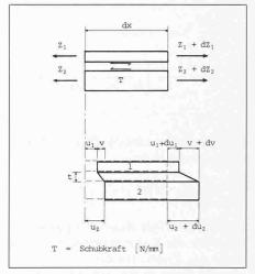
Bild 3. Kräfte und Verformungen am Element
