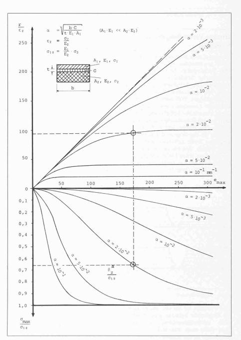
Bild 5. Zusammenhang zwischen Rissabstand und Rissbreite
