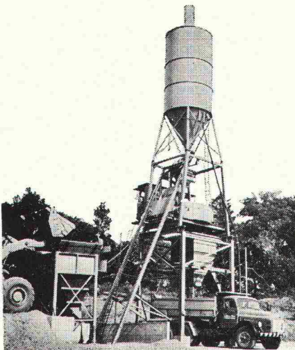
Standard-Betonanlagen AEBl, 4 Typen zwischen 20 m 3 und 60 m 3 Festbeton pro Stunde.
