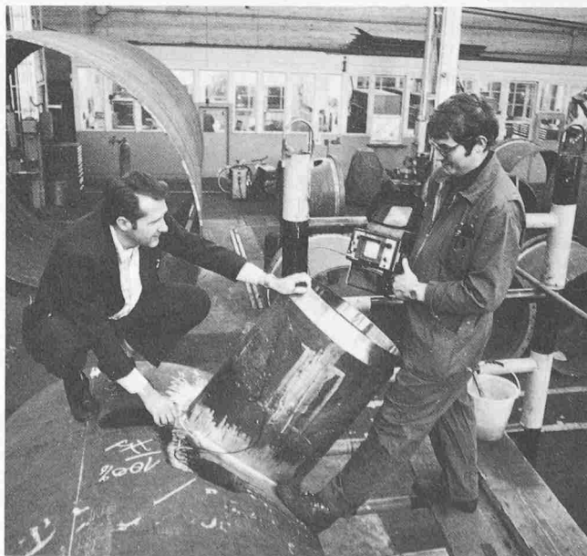
Bild 16. Ultraschallprüfung durch einen Sachverständigen des SVDB einer Stutzenschweißung an einem Wärmeaustauschermantel für das Kernkraftwerk Leibstadt. Der Prüfer (links) führt mit der rechten Hand den Prüfkopf und beobachtet den Bildschirm des Prüfgerätes
