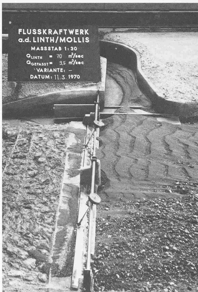
Bild 6. Bei bestehender Fassungsanlage starkes Eindringen von Geschiebe
