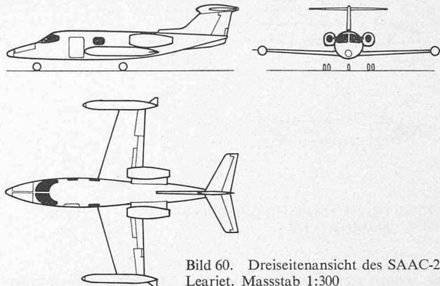
Bild 60. Dreiseitenansicht des SAAC-23, Learjet. Massstab 1:300
