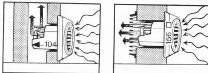
Der kleinste, preisgünstige Druckventilator mit der grossen Leistung: 100 m<sup>3</sup>/h. Für Neubauten und nachträglichen Einbau an bestehende Luftkanäle. Lageunabhängig. Modelle für Einbaurohre von 100 und 115 mm  $\varnothing$ , mit oder ohne Verschluss, Kontrolllampe und Zugschalter.
