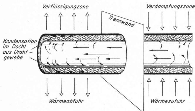
Prinzip des Q-Dot®-Heizrohres. In einer hermetisch verschlossenen Röhre ist ein Kältemittel eingeschlossen. Wird auf einer Seite der Trennwand — hier im Bild ist es die rechte — Wärme zugeführt, so verdampft es und strömt in der Rohrmitte zur anderen Seite, wo es sich an der kalten Wand verflüssigt. Das Kondensat wird im Docht durch Kapillarkräfte zur Verdampferzone zurücktransportiert.
