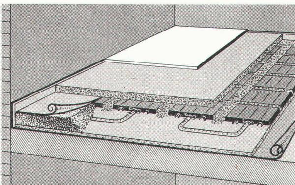
Schnittzeichnung durch die neue Konstruktion bei Unterlagsböden:
