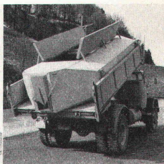
TIMPEX Warmhaltesilo für Belagsmisch- gut bei Handeinbau, Fassungs- vermögen ca 7 t
