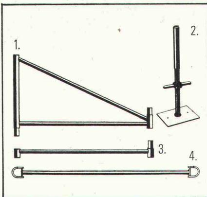
Ein ETEM-Turm besteht aus vier Bauelementen, die ohne Werkzeug zusammengefügt werden können: 1. Rahmen, 2. Fuss- bzw. Kopfspindel, 3. Endstrebe, 4. Horizontal-Diagonale. Das schwerste Element wiegt bloss 10,5 kg.
