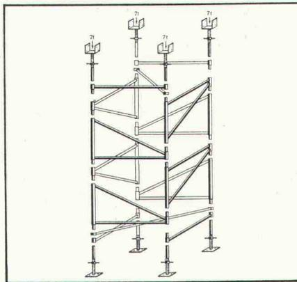
Die einzelnen Bauelemente können nur in der richtigen Reihenfolge zusammengesteckt werden. Eine Fehlmontage ist ausgeschlossen.
