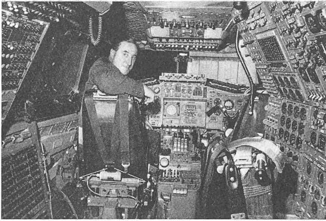
Blick in das Cockpit des britischen Concorde-Prototyps 002. Bei den Vorserienmodellen wurde die Instrumentierung geändert und ergänzt durch eine vollautomatische Flugregelanlage. Am Pilotenplatz der BAC-Chefpilot Brian Trubshaw
