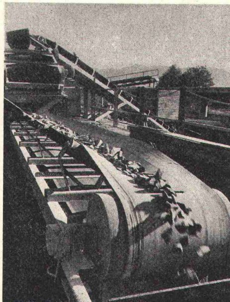
Trommelmotoren als staub-, spritz- und strahlwassergeschützte Bandantriebe für den rationellen Umschlag von Schüttgütern aller Art.
