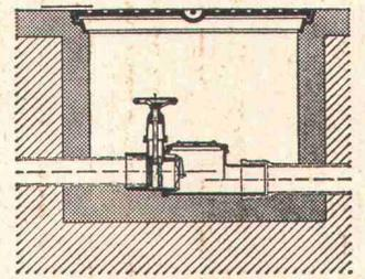
Rückstaudoppelverschluss TRIPLEX für durchgehende Leitungen
