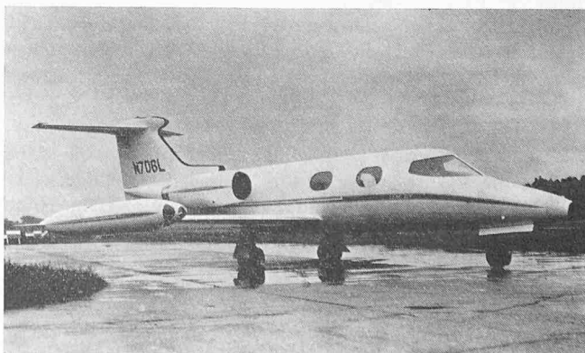
Das zweistrahlige Geschäftsreiseflugzeug Learjet, die bisher erfolgreichste Maschine dieser Klasse (Entwicklung 1959–1962) (Werkphoto FFA)
