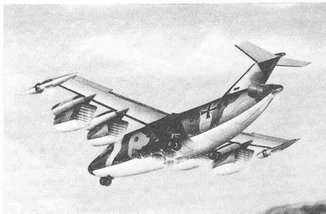
Zeichnung des senkrecht startenden Transporters für etwa 100 Personen, der unter der Bezeichnung HFB 600 bekannt war. Dieses Projekt wurde von H.-L. Studer im Jahre 1967 übernommen. Man erkennt deutlich die Schubablenklappen an den Haupttriebwerken, die Steuerdüsen an den Flügelspitzen und am Rumpheck sowie die Hubtriebwerke am Rumpf (Werkbild HFB)
