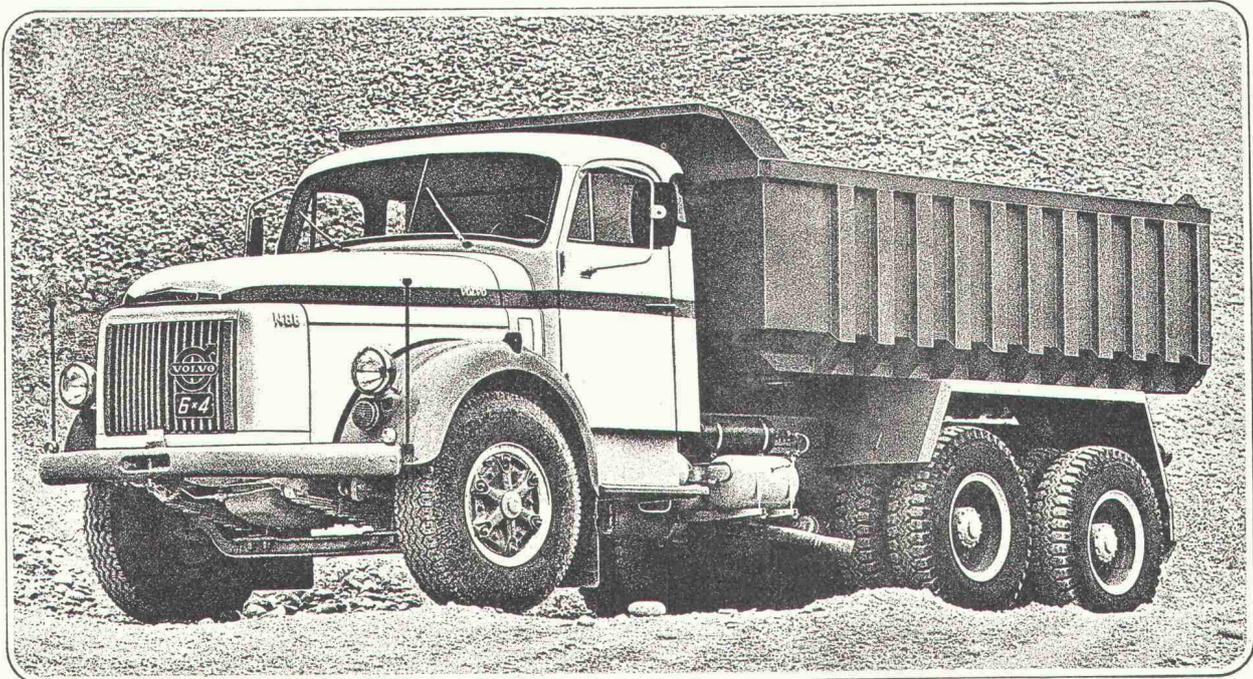
Das ist ein Volvo NB 88 <6x4> mit einem Spezialaufbau\* für 9 m<sup>3</sup> Gestein.
