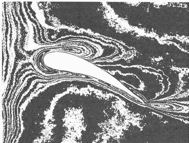
Aufzeichnung von laminaren Strömungen und Turbulenzen an einem Tragflügelprofil
